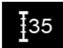
El Indicador de Profundidad muestra la profundidad máxima que la aguja seleccionada puede alcanzar durante un procedimiento. Si la profundidad es superada, la Guía de Aguja no será capaz de mostrar la ubicación de la punta de la aguja temporalmente, ya que se ha movido fuera de la imagen de ultrasonido. La punta de la aguja se mostrará de nuevo cuando la posición de las agujas es corregida por el usuario.
